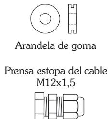
**Advertencia:** La introducción del cable en la parte inferior de la carcasa está señalizada. Se coloca la arandela de goma y el prensa estopa del cable (ambos incluidos en el envío).
