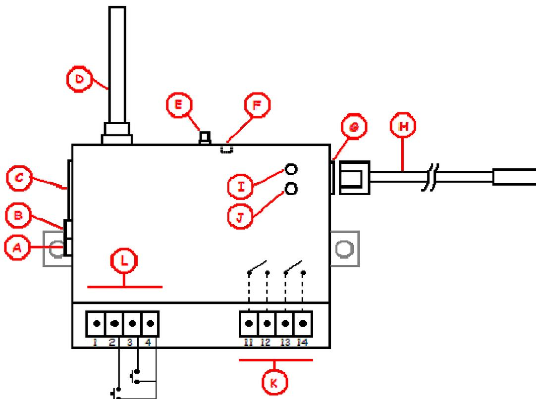
**A:** Es la entrada de alimentación. Para carga de baterías se recomienda conectar el adaptador que se proporciona con el equipo. Si no se conectan baterías al equipo se puede introducir fuentes de hasta 28 VDC que suministren unos 4 W.
