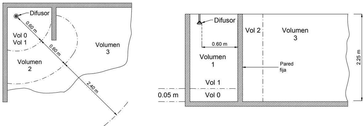
Figura 7 – CABINA DE DUCHA PREFABRICADA
