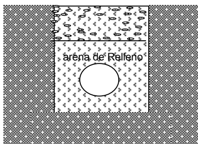
a) Tubo en recubrimiento de arena, resistencia a la compresión mínima 450 N.
