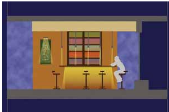
Barra iluminada con HYDROSTAR® Productos utilizados: 5 HYDROSTAR® LED. 2 OT 9/100-240/350 W Potencia total: 18 W
