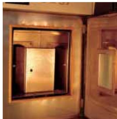
**Ensayo en recinto climático que permite recrear las condiciones de humedad y de condensación**
