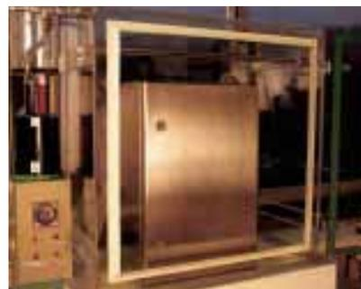
**Simulación de la exposición en atmósfera industrial en una estufa de SO<sub>2</sub> (dióxido de azufre)**
