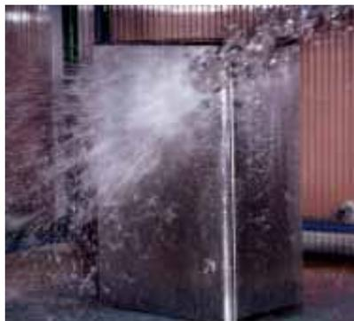
**Ensayo de protección contra proyecciones de agua IP x 6**
