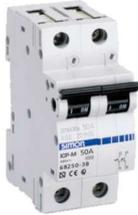
El interruptor general automático (IGA) tiene como finalidad interrumpir el suministro de energía eléctrica a la instalación en el momento en que se supera la capacidad de los cables que llegan desde el contador a nuestra vivienda. Además sirve como control para la totalidad de la instalación de la vivienda de tal manera que actuando sobre él y llevándolo a la posición de abierto (generalmente con las palancas hacia abajo) dejaremos sin tensión a toda la instalación eléctrica de la vivienda.
