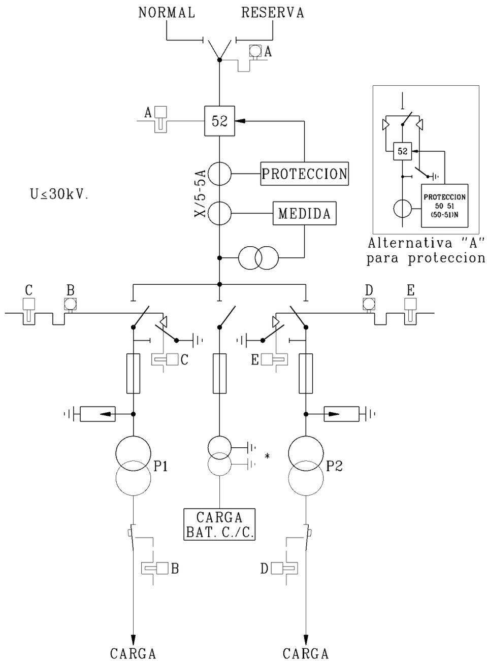
\* Solo necesario si la tensión secundaria de P1 y P2 no es B.T. Será un trafo de tensión monofásico.
