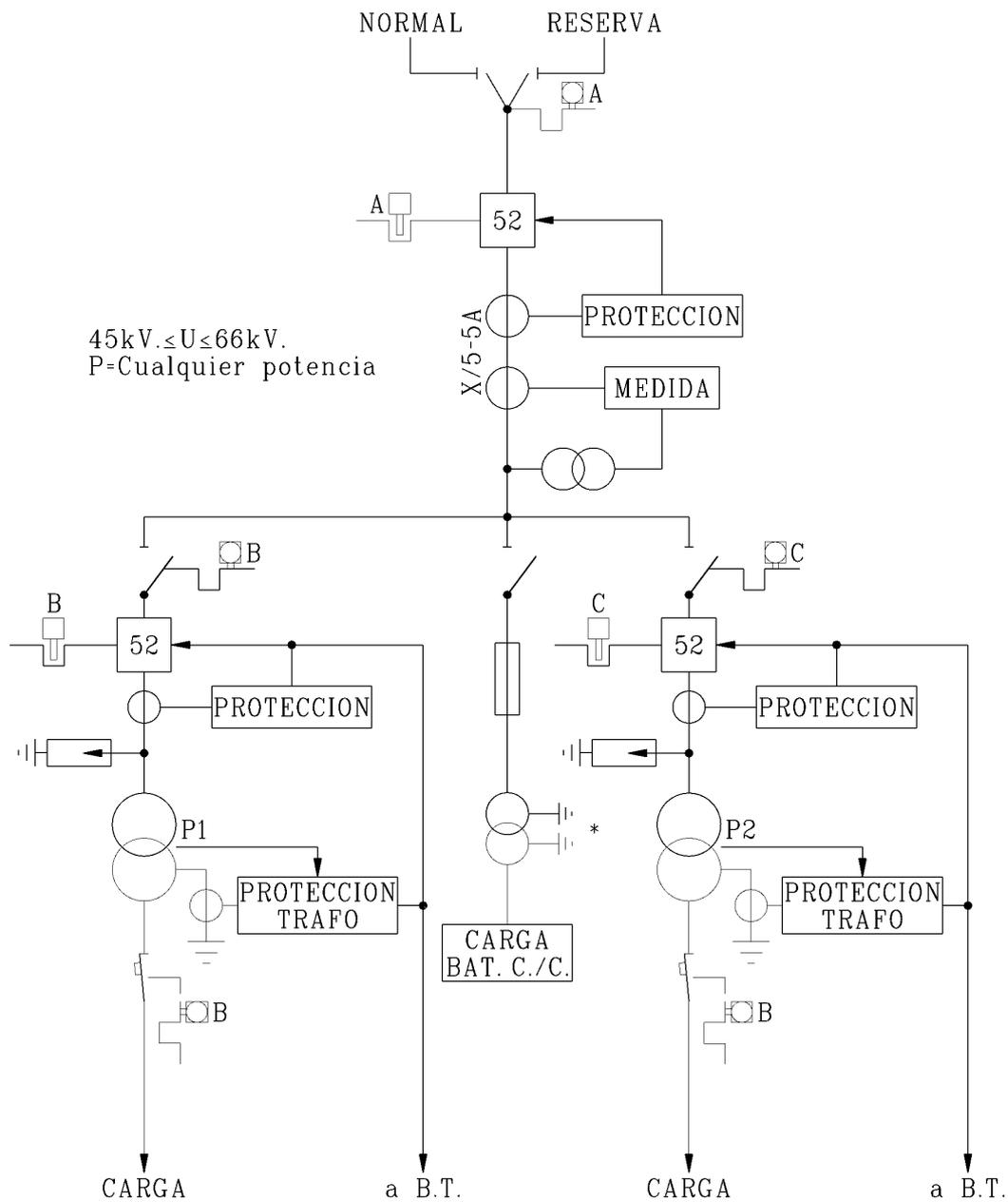
\* Solo necesario si la tensión secundaria de P1 y P2 no es B.T. Será un trafo de tensión monofásico.
