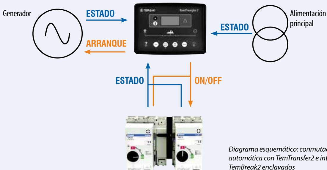
Diagrama esquemático: conmutación automática con TemTransfer2 e interruptores TemBreak2 enclavados
