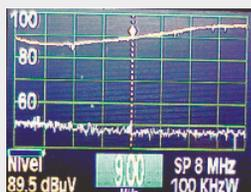
Segundo, calcular la atenuación de la señal en el canal de retorno por comparación con la señal medida directamente
