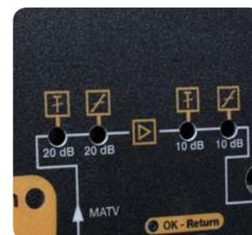
Diagrama de bloques de la central para facilitar la instalación y el ajuste.
