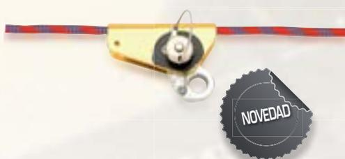
Dispositivo anticaídas para línea de anclaje flexible con cuerda de 11 mm que permite el movimiento vertical del usuario sin necesidad de cambiar su posición. En caso de caída se bloquea automáticamente. Según norma EN 353-2.
