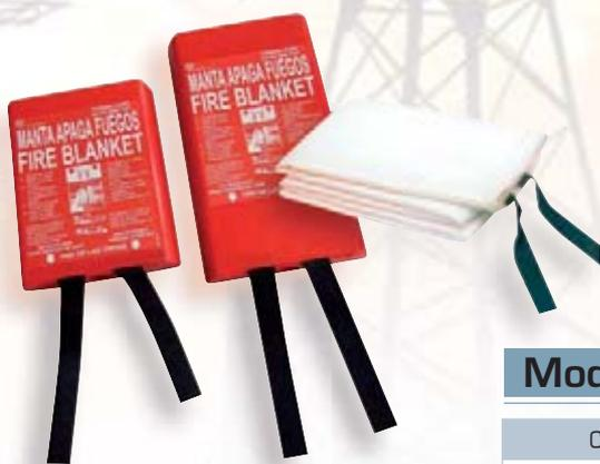
Manta ignífuga fabricada en tejido ignífugo a base de fibra de vidrio incombustible recubierta por ambas caras por silicona especial resistente a altas temperaturas. Dispositivo de uso inmediato. Soporta temperaturas de hasta 1100°C durante más de 15 min. Especialmente eficiente donde se desaconseja el uso de extintores. Suministrada en un estuche de plástico rígido de color rojo. Según UNE-EN-1869:97
