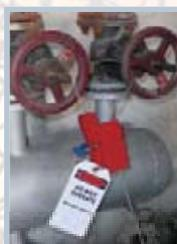
Utilización para bloquear válvulas de compuerta de diferentes tamaños como también múltiples válvulas. Más ligero que las cadenas, el dispositivo es fácil de transportar y usar.
