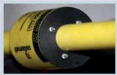
Detector de tensión bipolar con sondas de impedancia para redes de MT y señalización óptica de la presencia de tensión.
