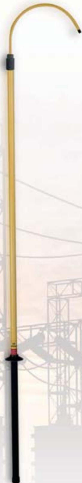
Pértigas de salvamento de un solo tramo fabricada en tubo de poliéster y fibra de vidrio de Ø 32 mm dotada de obturaciones antihumedad en ambos extremos, guardamanos, empuñadura, contera, cabezal métrico M-10 y gancho de salvamento.
