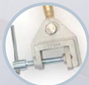
Equipo de puesta a tierra y cortocircuito para subestaciones de media tensión. El objetivo principal de su instalación es la protección del trabajador ante la puesta en funcionamiento accidental o un posible retorno de tensión durante los trabajos de reparación. Las pinzas MPU se pueden fijar a los conductores cilíndricos, pletinas, barras de distribución flexibles o puntos de fijación mediante apriete por tornillo. Según norma IEC 61230.
