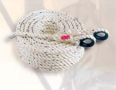
Rollo de cuerda de 16 metros y 14 mm de diámetro con guardacabos en los extremos para usar con el anticaídas deslizante modelo SO-28. Según norma EN 353-2.
