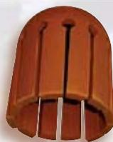
Fabricado en caucho, se utiliza para el aislamiento provisional de conductores desnudos a su paso por aisladores de baja tensión. Tiene forma de campana y está provisto de ranuras para el paso de los conductores.
