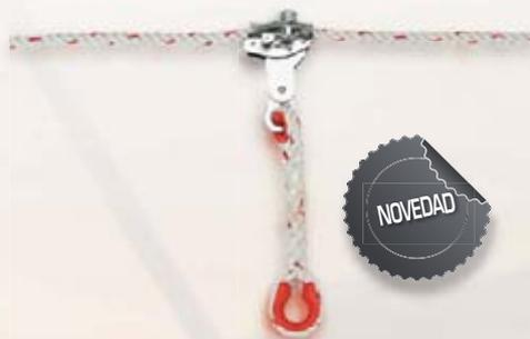
Dispositivo anticaídas para línea de anclaje flexible con cuerda de 14 mm provisto de cierre de seguridad y sistema que evita la colocación errónea del equipo. Permite el movimiento vertical del usuario sin necesidad de cambiar su posición. En caso de caída se bloquea automáticamente. Según norma EN 353-2.
