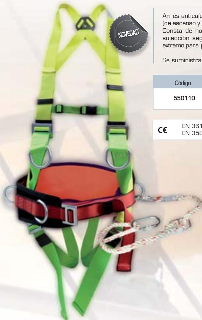
Arnés anticaídas según norma EN 361. Dispone de dos puntos de anclaje (de ascenso y descenso): uno en la zona dorsal y otro en la zona abdominal. Consta de hombreras y perneras regulables, así como un cinturón de sujeción según norma EN 358 con dos enganches laterales en cada extremo para poder acoplar un elemento de amarre.
