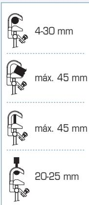
Equipo de puesta a tierra y cortocircuito para cuadros eléctricos de baja tensión. El objetivo principal de su instalación es la protección del trabajador ante la puesta en funcionamiento accidental o un posible retorno de tensión durante los trabajos de reparación. Las pinzas MPUE se pueden fijar en conductores cilíndricos descubiertos, pletinas, barras (de distribución) de flexión o puntos de fijación. Cada una tiene su propia empuñadura fija.
