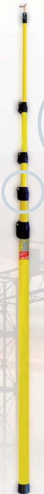
Pértiga telescópica de múltiples tramos fabricada en tubo de poliéster reforzado con fibra de vidrio de sección circular variable que permite trabar cada tramo automáticamente. El tramo superior está relleno con espuma que cumple con la norma IEC 60855. La longitud de cada tramo se puede ajustar según sea necesario mediante de un sistema de ajuste con asas de bloqueo. Todos los modelos se suministran con cabezal Universal y gancho de maniobra.
