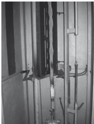
Se comprueba la resistencia al avance de las llamas de un conjunto de muestras (cableadas trenzadas en haz) de un determinado tipo y sección de cable. Si el cable a ensayar supera los 25 mm de diámetro exterior se utiliza una sola muestra.
