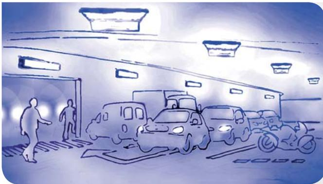
**Estacionamientos con alumbrado normal temporizado:** cuando el alumbrado normal se autoapaga, las rutas de evacuación se hacen invisibles si las luminarias de emergencia instaladas no son permanentes.
