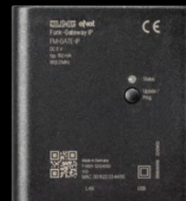
El interface IP para montaje en superficie permite hasta 5 conexiones simultáneas de dispositivos móviles. 24 canales para manejar otros tantos actuadores eNet, 20 listas de favoritos y 16 escenas le dan un enorme potencial de funcionalidad. Funciona con alimentación USB y conexión a red a través de un router WLAN. Todo el manejo se realiza desde una App gratuita.
