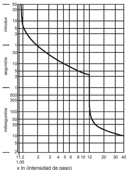
Los interruptores protectores de motor son los aparatos que aseguran el mando y la protección de pequeños motores mediante los dispositivos magnetotérmicos incorporados. Los elementos magnéticos ofrecen una elevada capacidad de corte que protege contra los cortocircuitos. Los elementos térmicos protegen contra las sobrecargas.
