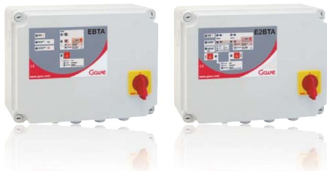
Los equipos ExBTA son una solución específica para las aplicaciones de rebombeo de aguas residuales. Incorporan una entrada específica para una boya que nos indica el nivel de alarma. Al cerrar el contacto esta boya el panel exterior ilumina el símbolo de alarma y la electrónica activa una señal de alarma para enviar al exterior. El equipo incorpora una protección adicional contra el agarrotamiento de la bomba mediante una entrada dedicada al interruptor klixon de la bomba.
