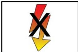
La producción de chispas, arcos o temperaturas excesivas que pueden actuar como fuente de ignición se impiden con medidas adicionales y con un grado de seguridad aumentado.
