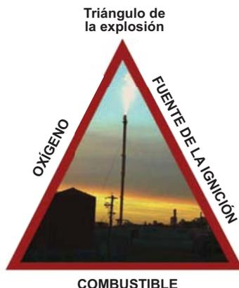
Para que pueda ocurrir una explosión, se deben dar las tres condiciones. Ver diagrama del triángulo de la explosión
