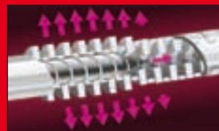
La expansión regular de las láminas en materiales de construcción macizos. En material macizo las láminas producen presión de expansión por toda una amplia superficie, con lo que se obtiene una resistencia especialmente elevada (hasta 3,1 kN admisibles en hormigón para el 14 mm.)
