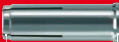
La **unidad de casquillo mas cono de expansión** permite una máxima resistencia en hormigón comprimido y traccionado. El casquillo de anclaje se estampa sin arranque de virutas de una pieza única y por lo tanto resulta especialmente resistente.
