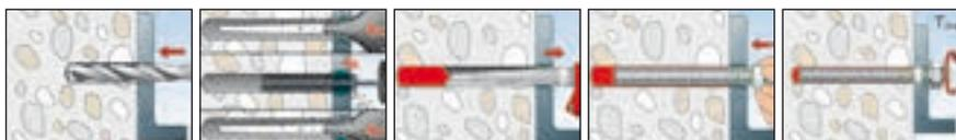
manualmente (sin herramienta de colocación) girando ligeramente hasta el fondo del taladro.
