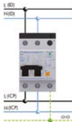
Los protectores de la serie **IGA TEST COMPACT** cortan la línea cuando detectan una sobretensión permanente (por ejemplo, fallos de neutro), protegiendo así los equipos instalados aguas abajo.
