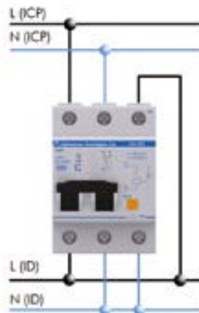
Los protectores de la serie **IGA TEST** cortan la línea cuando detectan una sobretensión permanente (por ejemplo, fallos de neutro), protegiendo así los equipos instalados aguas abajo.
