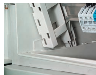
Con un simple desplazamiento de las fijaciones es posible ajustar la profundidad de montaje del perfil DIN, de las placas de montaje parciales, de las placas para los interruptores Tmax y de los conjuntos de canalización para cableado.
