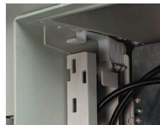
Los soportes y fijaciones permiten el montaje a presión del bastidor en el armario.
