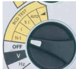
Rango de selección claro para condiciones pobres de luz.
