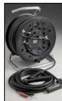
1000-809 Sondas de medida Kelvin disponibles en 30, 50 y 100 m de longitud
