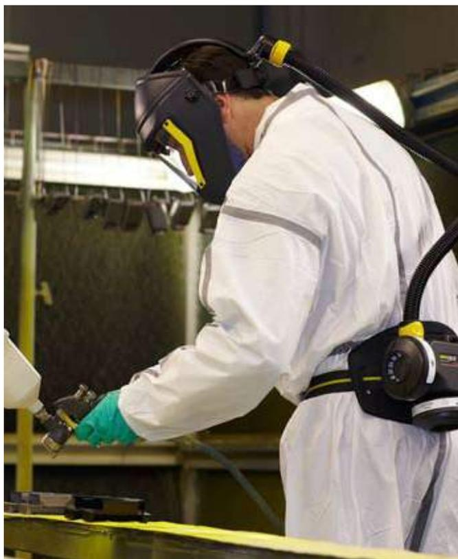
La evolución de los equipos de protección respiratoria nos lleva a los equipos motorizados filtrantes. Éstos equipos cogen el aire desde la espalda del trabajador y lo filtran haciendo llegar el aire filtrado al usuario con una presión positiva dentro del capuz que incrementa la seguridad y el confort del usuario.
