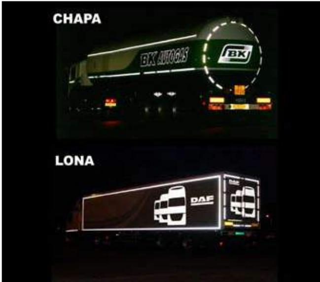
El reglamento CEPE/ONU 48 indica la voluntariedad u obligatoriedad de marcar con materiales retrorreflectantes la parte trasera y lateral de los diferentes tipos de vehículos, especificando como obligatorio el marcado del contorno de los vehículos a motor, de al menos 4 ruedas, destinados al transporte de mercancías, cuyo peso máximo autorizado exceda los 7,5 Tm y su anchura sea superior o igual a 2,1 metros.
