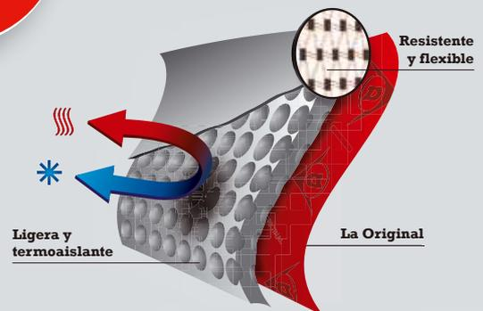
Purofort® es el material exclusivo de Dunlop® con millones de burbujas de aire distribuidas uniformemente para conseguir un producto ligero y termoaislante además de una estructura reticular que proporciona flexibilidad y resistencia.
