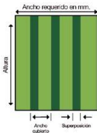
\* = Ancho cubierto: 250 mm.
