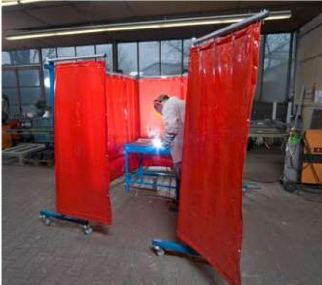
La base del sistema TRANSFLEX es una sólida estructura recubierta con una capa plástica. La construcción por módulos permite una amplia gama de posibilidades.
