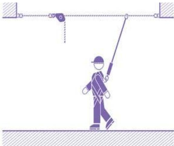
Las líneas de vida anticaídas temporales suelen ser de cuerda o cinta. Son muy fáciles de instalar ya que sólo requieren 2 puntos de anclaje lo suficientemente resistentes y situados a la misma altura. Mediante el tensor se estira la cuerda para intentar evitar en lo posible la desviación o flecha de caída en caso de caer el trabajador al vacío. Siempre deberá existir por tanto un espacio libre de caída por debajo de los pies del trabajador.
