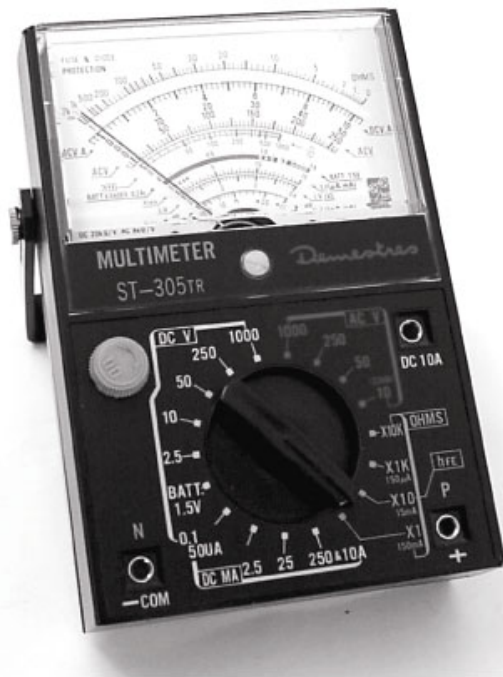
Figura 8.2. Polímetro analógico con escalas.
