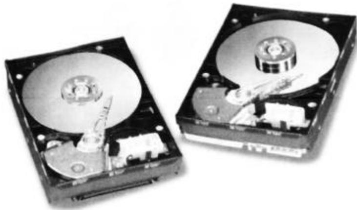
**Figura 11.** Interior de un disco duro
