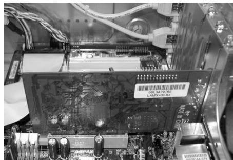
Insertar las tarjetas y cerrar la caja
