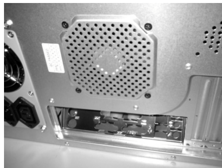
Colocar la pletina de los conectores
