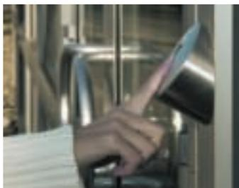
El producto está compuesto por una placa con microprocesador, un puerto de comunicación RS232 y un lector biométrico de huella dactilar mediante sensor térmico.
