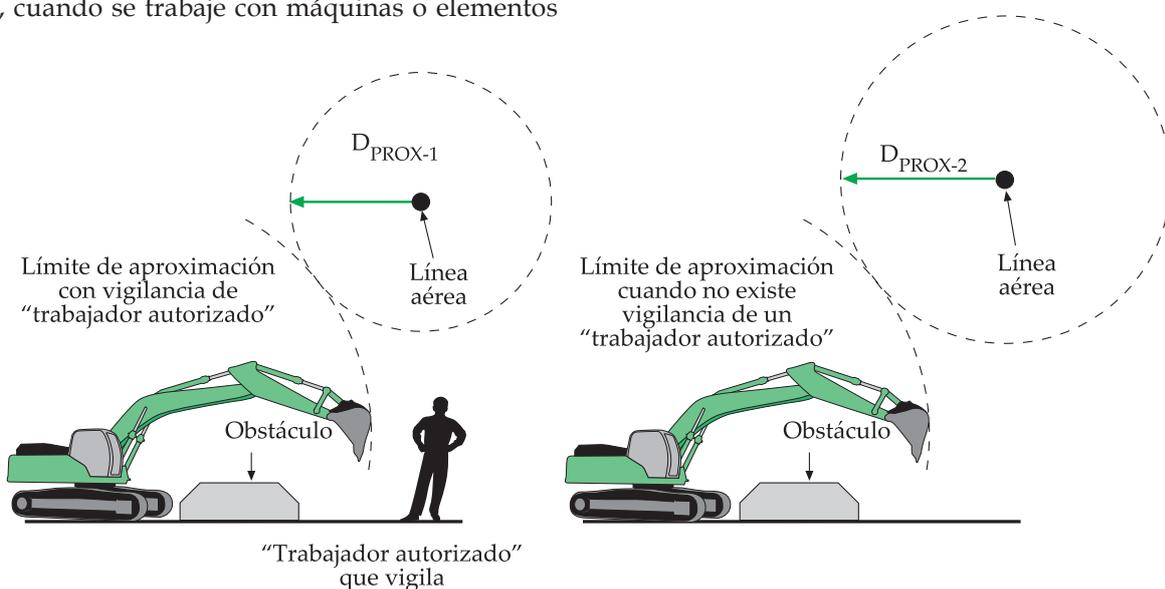
Figura 28. Ejemplo de medidas preventivas en trabajos en proximidad con máquinas.
