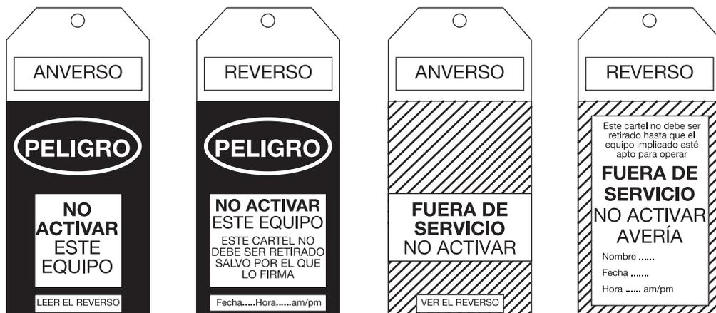
Figura 8. Ejemplos de carteles que pueden colocarse sobre los dispositivos de maniobra para prohibir su accionamiento.
