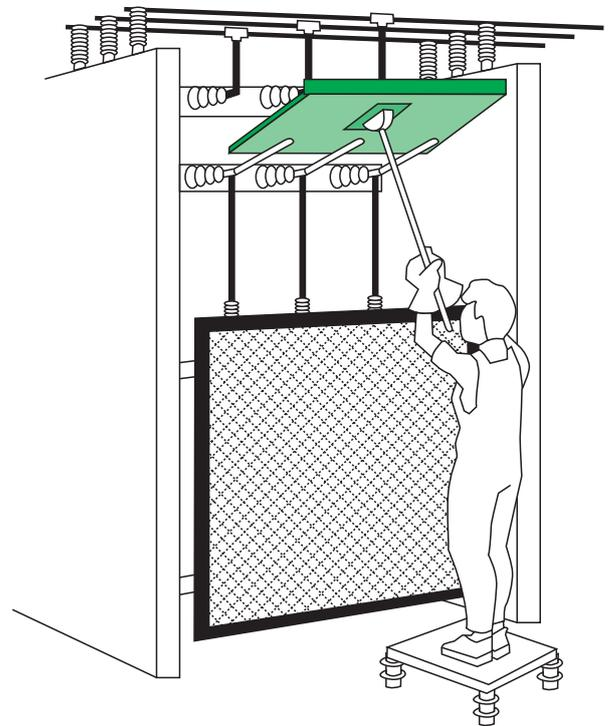
Figura 9. Bloqueo físico por interposición de una placa aislante entre las cuchillas de un seccionador
