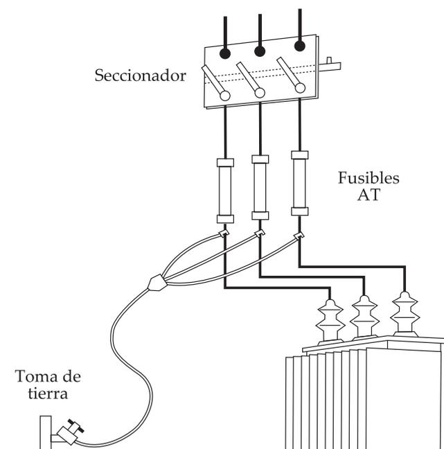
Figura 17. Colocación de la puesta a tierra y en cortocircuito para reposición de fusibles.
