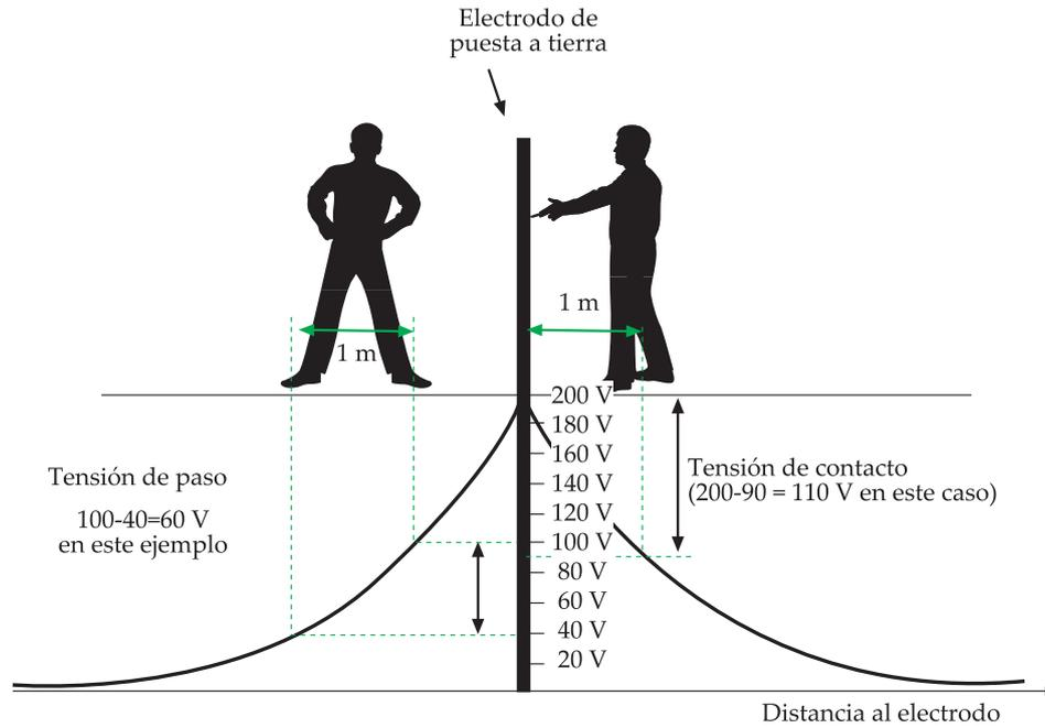
Figura 13. Tensiones de paso y de contacto.
