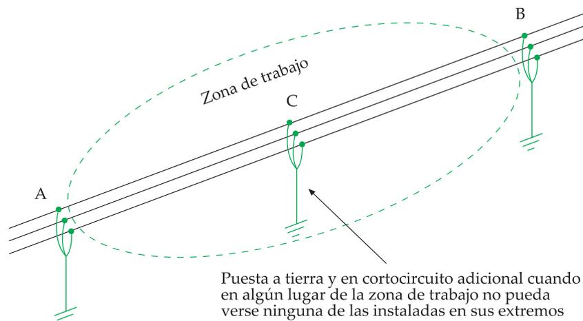
Puesta a tierra y en cortocircuito adicional cuando en algún lugar de la zona de trabajo no pueda verse ninguna de las instaladas en sus extremos
