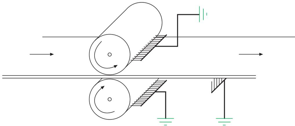
Figura 34. Eliminación de la electricidad estática acumulada entre los rodillos y la banda continua de papel.
