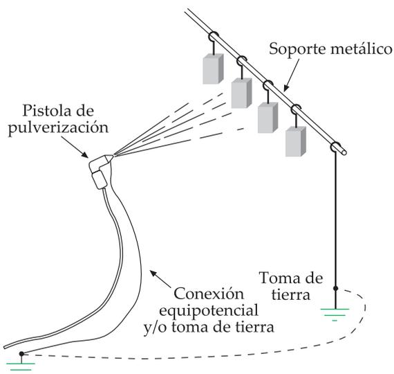
Figura 35. Conexión equipotencial en proceso de pintura a pistola.
