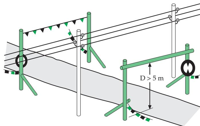
Figura 31. Ejemplo de sistema de protección para trabajos en proximidad de líneas aéreas.
