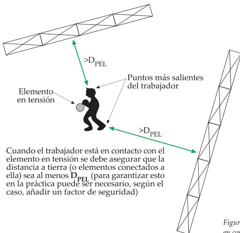
Figura 22. Método de trabajo a potencial: trabajador en contacto con el elemento en tensión.
