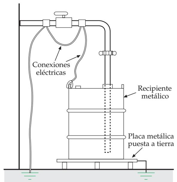
Figura 36. Conexión equipotencial en proceso de trasvase de líquidos inflamables.
