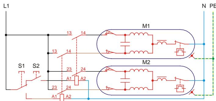
Cuando sea necesario que un solo pulsador accione varias persianas se procederá a la colocación de relés de accionamiento tal y como muestra la figura adjunta, eliminando así los problemas originados por las corrientes de retorno. Se debe proceder de igual manera en controles domóticos. Cada sentido de giro de un único motor debe ser accionado por un relé
