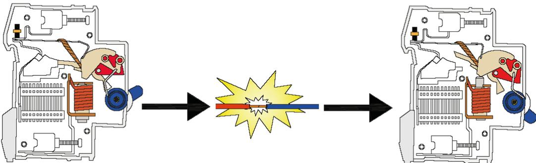
Al producirse un cortocircuito, breve en tiempo pero de una gran intensidad, genera el campo magnético necesario para que la bobina impulse el núcleo del electroimán y dispare el circuito magnético del interruptor (**Corte inmediato**).
