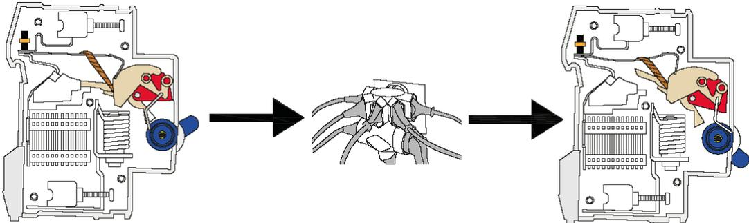
Cuando se produce una sobrecarga debido a un exceso de carga en el circuito, la temperatura de la lámina bimetálica aumenta durante un periodo prolongado de tiempo hasta su deformación, haciendo disparar el circuito térmico del interruptor (**Corte lento**).
