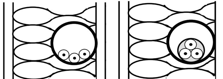
*Figura B Tubos en canalizaciones empotradas en paredes térmicamente aislantes*
