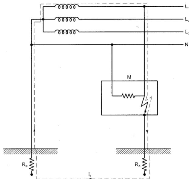
Figura 5. Instalación TT con un defecto a tierra.
