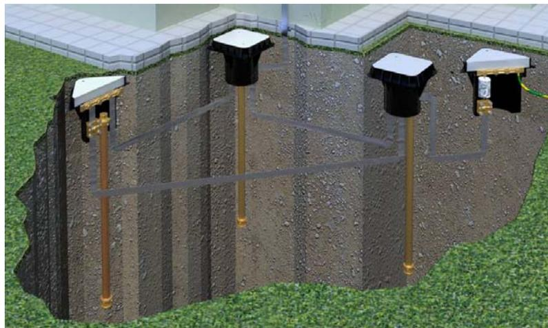
Se recomienda la utilización de 3 electrodos en configuración de **triángulo**.
