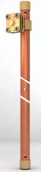
Consisten principalmente en un tubo hueco de cobre relleno con una mezcla de compuestos iónicos. El producto absorbe la humedad ambiental y se disemina en el terreno que rodea al electrodo, aportando iones libres y reduciendo gradualmente la resistividad del terreno.
