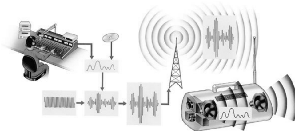
Sistema de transmisión y recepción de señal por radio
